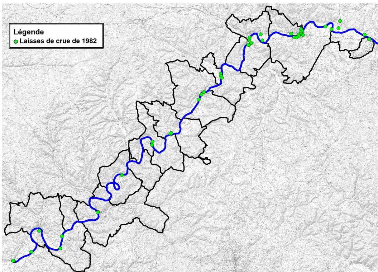
Figure 22 : Laisses de crue de 1982 utilisée pour la validation du modèle
