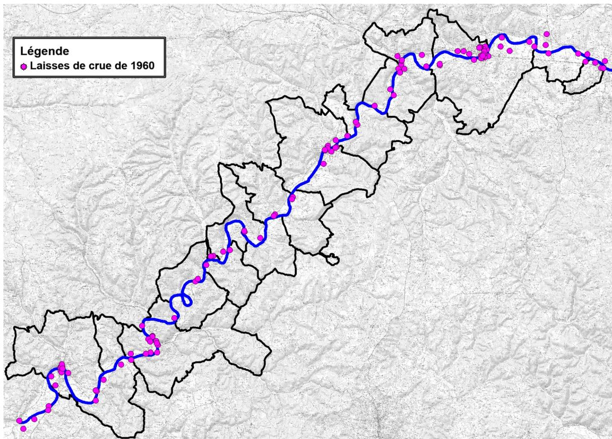
Figure 21 : Laisses de crue de 1960 utilisée pour le calage du modèle
