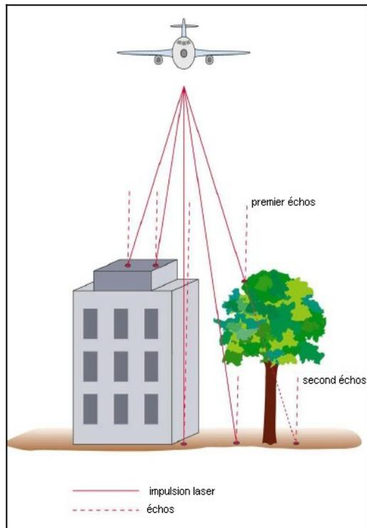
Le signal laser arrive au sol sous forme d'une tâche occupant une certaine surface, il peut alors n'être réfléchi que par morceaux : une partie est réfléchie par un objet en sursol, et l'autre atteint le sol pour s'y réfléchir.
