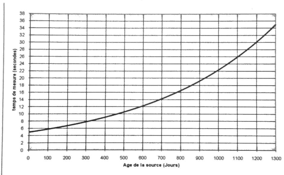
Dans ces conditions, l'appareil garantit que 95% des mesures réalisées sur un échantillon standardisé de concentration voisine de 1mg/cm<sup>2</sup> seront compris dans une fourchette de + ou - 0.1 mg/cm<sup>2</sup> de la valeur de cet échantillon.
